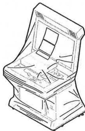
② 設置場所に移動して場所を確定した後は、4箇所のレベルアジャスターを持ち上げてキャスターを2～5mm浮かし、水平が確保できるように水準器で確認しながら調整します。
